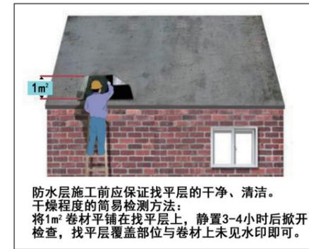
防水层施工前应保证找平层的干净、清洁。干燥程度的简易检测方法：将1m²卷材平铺在找平层上，静置3-4小时后掀开检查，找平层覆盖部位与卷材上未见水印即可。
