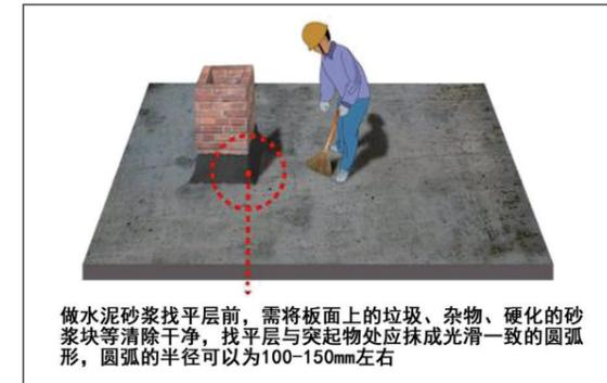
做水泥砂浆找平层前，需将板面上的垃圾、杂物、硬化的砂浆块等清除干净，找平层与突起物处应抹成光滑一致的圆弧形，圆弧形半径可以为100-150mm左右
