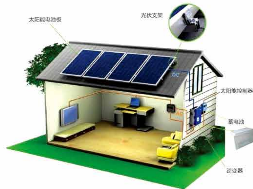
太阳能光伏发电系统组成
